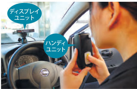
ハンディユニットで息を吹入すると、ディスプレイユニットにアルコールチェックの検知結果が表示されます。
